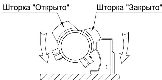
В случае необходимости настройки концевых выключателей открутить винт M4 на соответствующей шторке ого выключателя, повернуть его на оси на требуемый угол и зажать винт.
